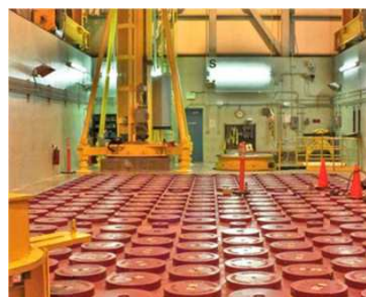
Figure 20 : Photo de l'intérieur de l'entreposage de type MVDS sur le site de Fort St. Vrain (États-Unis)
